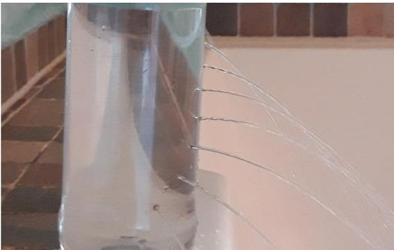
Der Versuch mit der Flasche zeigt uns, wie hoch die Drücke hinter einer Staumauer sind und mit welcher Kraft das Wasser durch die Druckrohrleitung eines Speicherkraftwerks strömt.
