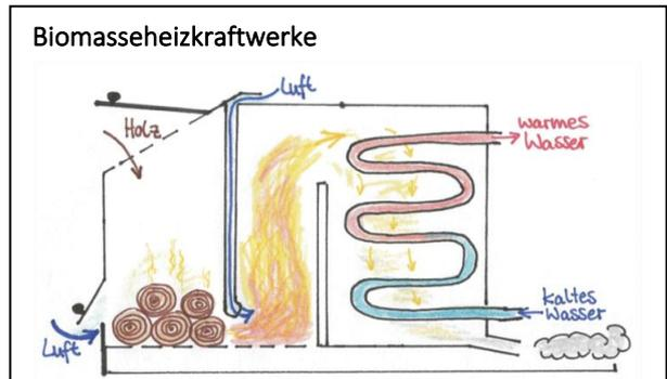
In **Biomasseheizkraftwerken** können aus Biomasse Wärme und Strom erzeugt werden. Dazu wird die Biomasse (z.B. Holzabfälle oder Biomüll) verbrannt.
