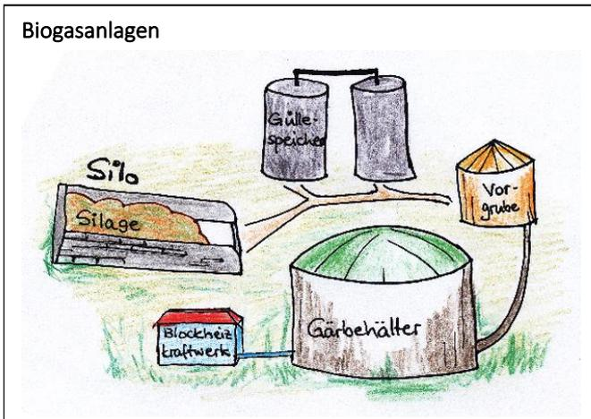
In **Biogasanlagen** werden verschiedene Ausgangsstoffe (z.B. .... und ..... ) in Biogas umgewandelt. Die Ausgangsstoffe werden dazu zunächst klein gehäckselt, vermischt und anschließend in den Gärbehälter (Fachbegriff = Fermenter) eingebracht. Er ist beheizbar, luftdicht und enthält ..... Diese zersetzen den Biomassemix zu Biogas. Biogas besteht v.a. aus ....., Kohlenstoffdioxid, Wasserdampf sowie weiteren Spurengasen (Gase in kleinsten Mengen) wie Ammoniak und Schwefelwasserstoff.
